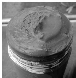
写真-5. 加圧後のグラウト状況
