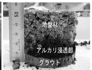
写真-6. アルカリ分の浸透状況(黒い部分がアルカリ浸透範囲)
