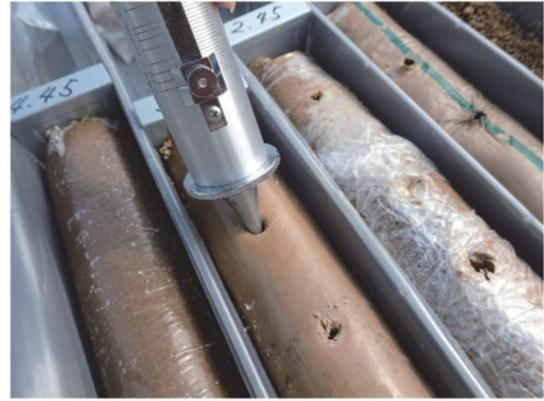
写真-1 ボーリングコアへの土壤硬度試験実施状況
